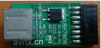
The above 6-pin to 16-pin conversion board, it is for Motorola radio and to use for connection on GM300、SM50、SM120、GM338、GM339、GM398、GM3188、GM3688、GM950I、CDM-750、 CDM-1250、CDM-1550、GM140、GM160、GM340、GM350、GM360、GM380、GM640、GM660、 GM1280、CM140、CM160、CM200、CM300、CM340、CM360、PM400、M1225、pro3100、 pro5100、pro7100、
