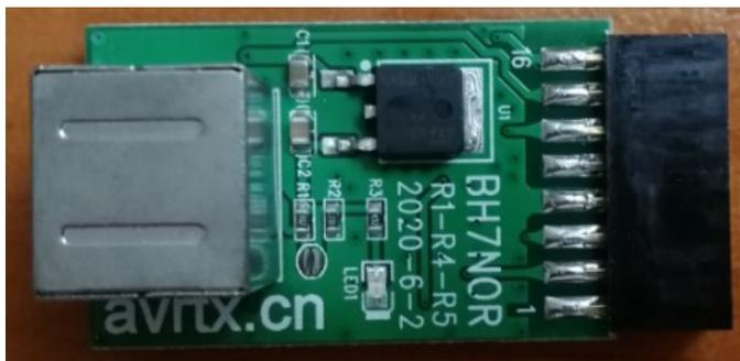
The above 6-pin to 16-pin conversion board, it is for Motorola radio and to use for connection on GM300、SM50、SM120、GM338、GM339、GM398、GM3188、GM3688、GM950I、**CDM-750**、**CDM-1250**、**CDM-1550**、GM140、GM160、GM340、GM350、GM360、GM380、GM640、GM660、GM1280、CM140、CM160、CM200、CM300、CM340、CM360、PM400、M1225、pro3100、pro5100、pro7100、
